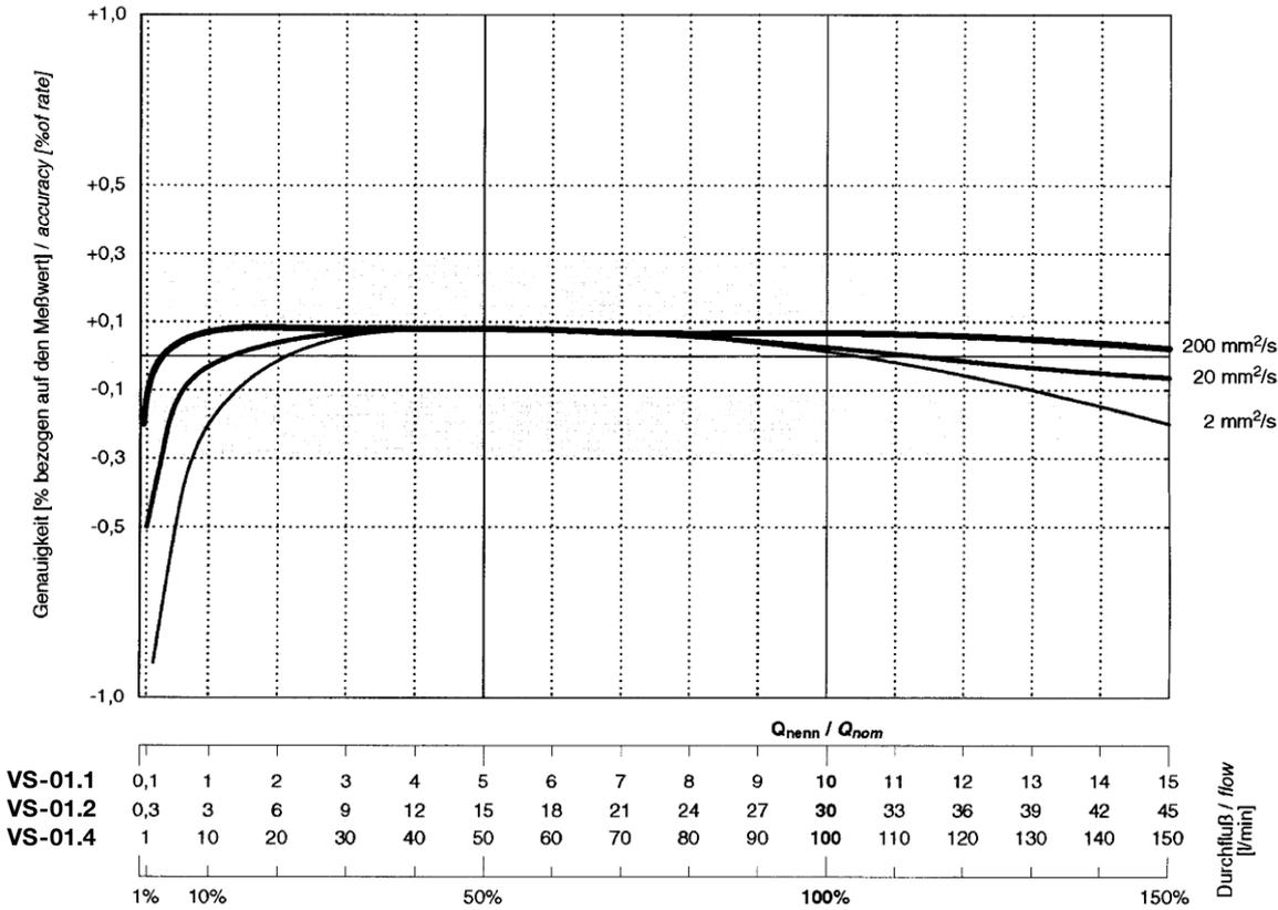
Das Diagramm zeigt die Charakteristik der Profimess Volumeter VS-01. Jeder Volumeter wird kalibriert, um die gerätespezifischen Werte zu dokumentieren.
